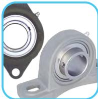
Os conjuntos da linha Alimentícia **FRM** foram desenvolvidos para serem resistentes à corrosão em ambientes ácidos, alcalinos e à névoa salina. Além dessas características, são relubrificáveis, trabalham em ambientes com temperatura de operação entre -30°C até +100°C e são intercambiáveis entre os correspondentes de ferro.
